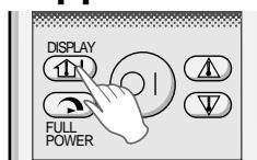
На дисплее показываются комнатная температура и МОНИТОР НАПРЯЖЕНИЯ.
