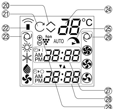
㉗ ИНДИКАТОР ТАЙМЕРА ВКЛЮЧЕНИЯ/ЧАСЫ
